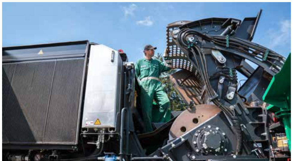
Von der Serviceplattform sind Zerkleinerungsraum und Motor mühelos erreichbar.
