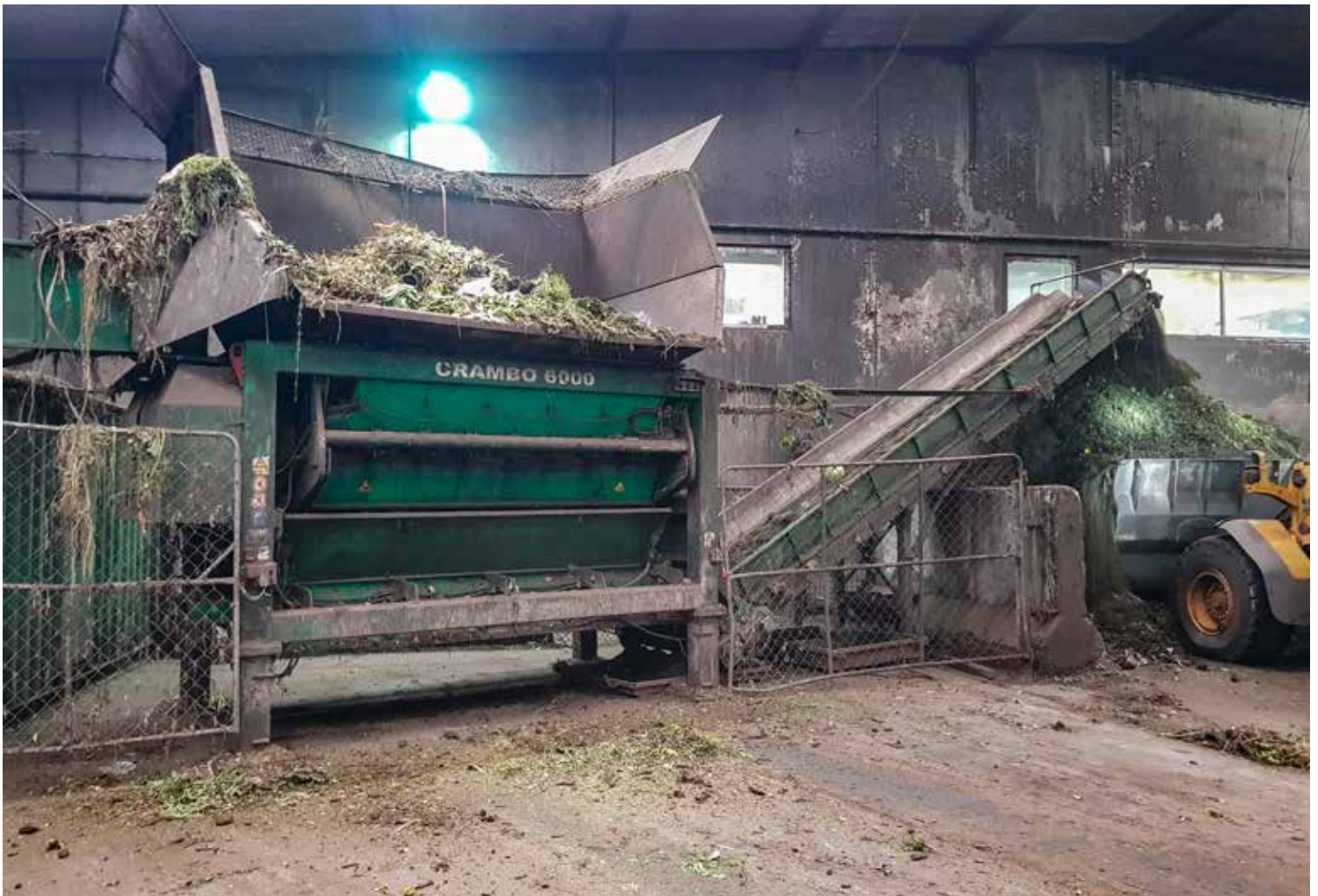
Ein stationärer Crambo übernimmt die Vorzerkleinerung des Bioabfalls.
