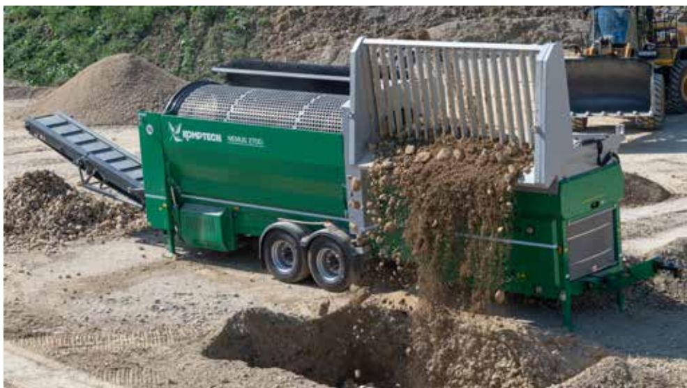
Das Absieben der „Bummer!“ wird durch das Bunkervorsieb wesentlich erleichtert.
