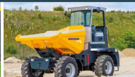
Bergmann 2090 R PLUS Mit absenkbaarem Wetterschutzdach.
