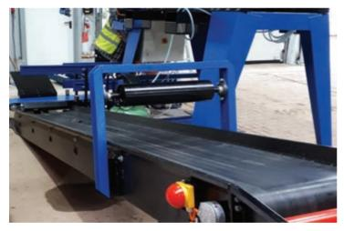
Auf Wunsch wird die Anlage mit einer Waage ausgestattet, welche das Absacken nach Gewicht ermöglicht.
