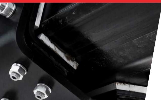
Gleitblöcke schützen den Metallrahmen eines Teleskopladers vor Verschleiß und Abnutzung. Um einen optimalen Schutz zu gewährleisten, ist es wichtig, hochwertige Gleitstücke zu verwenden und diese regelmäßig auszutauschen. Bei TVH finden Sie eine große Auswahl an hochqualitativen **Gleitstücken** für Teleskoplader.
