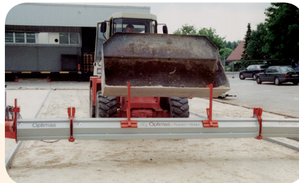
Einfacher Transport des montierten Planierhobels
