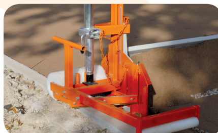
Sauberes Abziehen durch bewegliche Seitenklappen
