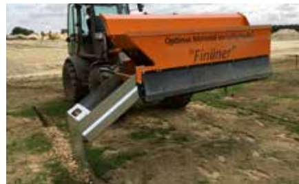
Verfüllen von Drainagegräben (Schaufel 1,0 m³ mit Rutsche lang und Materialleitblech)
