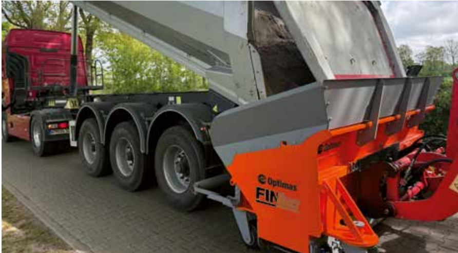
Schaufel 1,4 m³ mit Schubrollen und Wannenerhöhung
