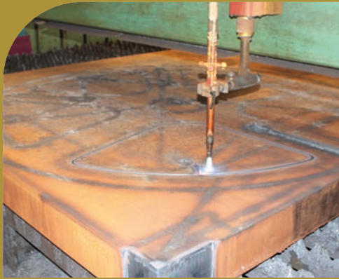
Fertigung eines Laufrades; Dimension: FM Ø 2625 x 190 mm; rundum laufende 30° Fase
