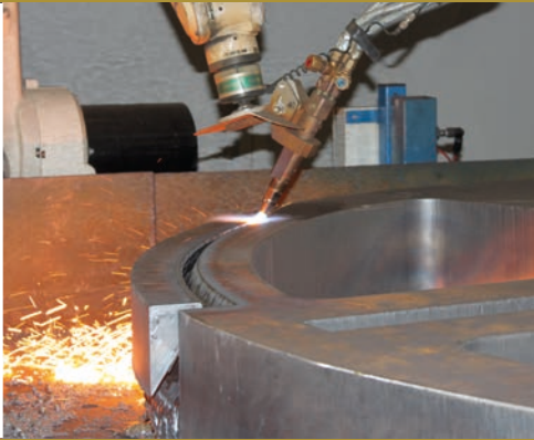
Fertigung eines Laufrades; Dimension: FM Ø 2625 x 190 mm; rundum laufende 30° Fase
